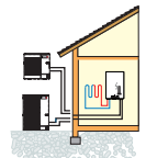
Apoyo mediante resistencia eléctrica
