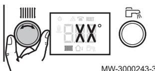
1. Ajustar el punto de consigna de temperatura o la temperatura ambiente en función de la configuración descrita más arriba girando el botón de ajuste
