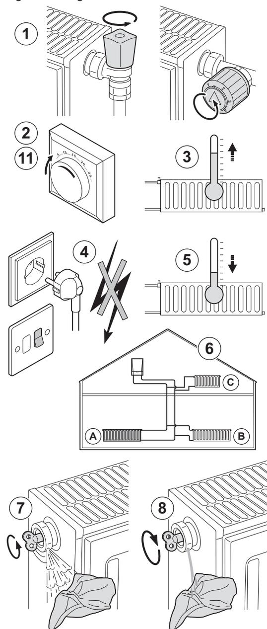
Se debe eliminar cualquier resto de aire en la caldera, los tubos o las válvulas para evitar ruidos no deseados durante la calefacción o al utilizar el agua. Para ello, llevar a cabo el siguiente procedimiento:
