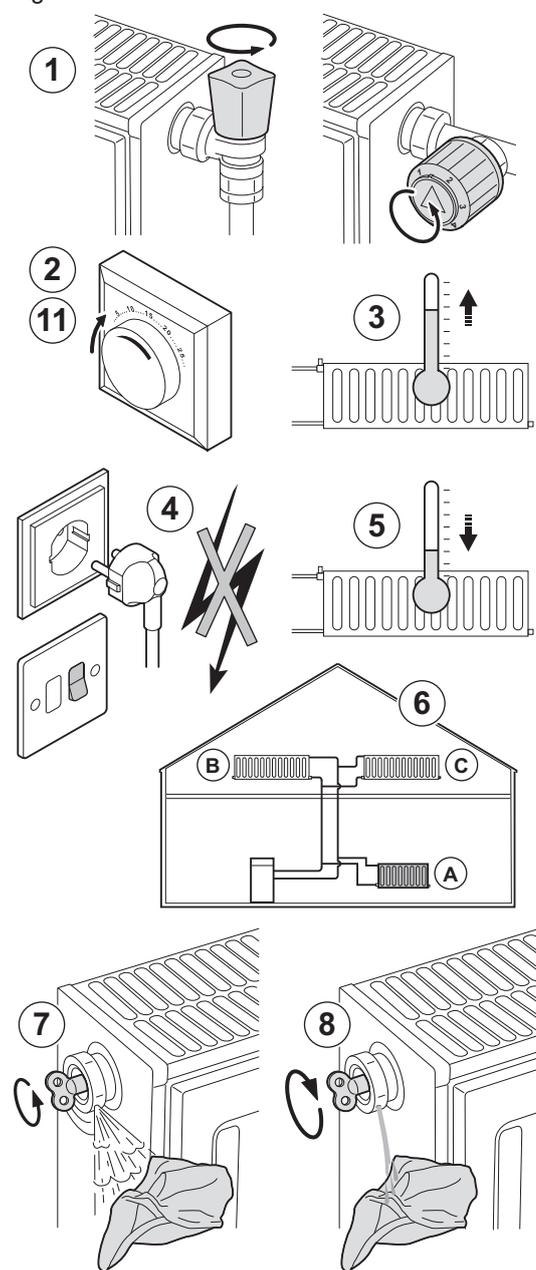
Se debe purgar cualquier resto de aire en la caldera, los conductos o las válvulas para evitar ruidos molestos durante el funcionamiento de la calefacción o al utilizar el agua.
