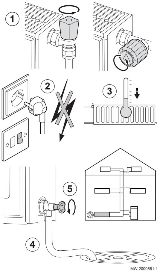
Puede ser necesario vaciar el sistema de calefacción central si hay que cambiar radiadores, en el caso de una fuga de agua importante o si existe riesgo de helada.
